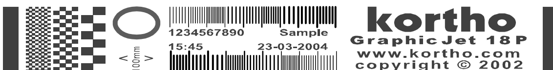
Fig. 9.7 Testafdruk met te lage snelheid afgedrukt, lengte > 100 mm
