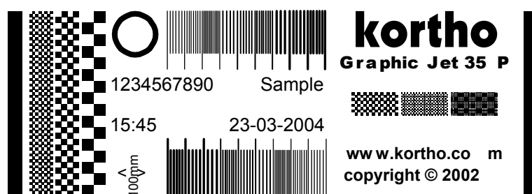
Fig. 9.9 Testafdruk 'Kortho35P' bij juiste afdruksnelheid en uitlijning, lengte = 100 mm
