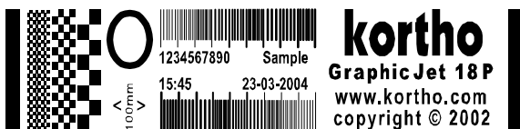
Fig. 9.6 Testafdruk met te hoge snelheid afgedrukt, lengte < 100 mm
