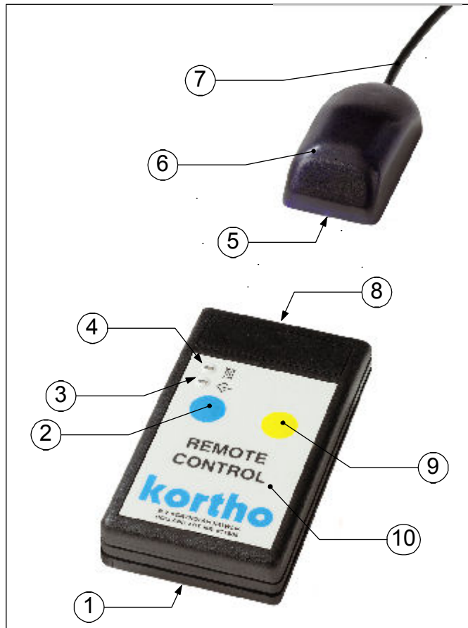
Fig. 2.16 Onderdelen infrarood apparaten voor afdrukbestandsoverdracht
