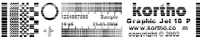
Fig. 9.5 Afdrukresultaat wanneer de sproeiers verstopt zijn met inkt/stof of door luchtbelletjes.
