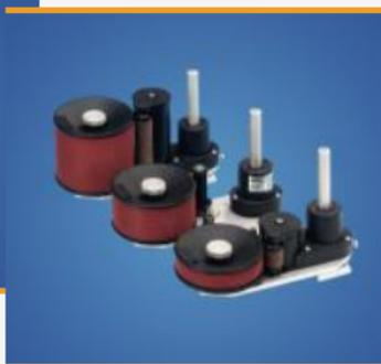
Auf der Textrolle werden die steckbaren Schrifttypen und/oder Klischees aus Gummi in beliebiger Anordnung platziert. Der Antrieb der Textrolle erfolgt durch das zu bedruckende Produkt, die Einfärbung geschieht dabei automatisch während der Rotation.
