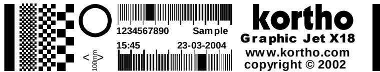
Fig. 7.11 Testlabel gemaakt met een juiste snelheidinstelling (X18)
