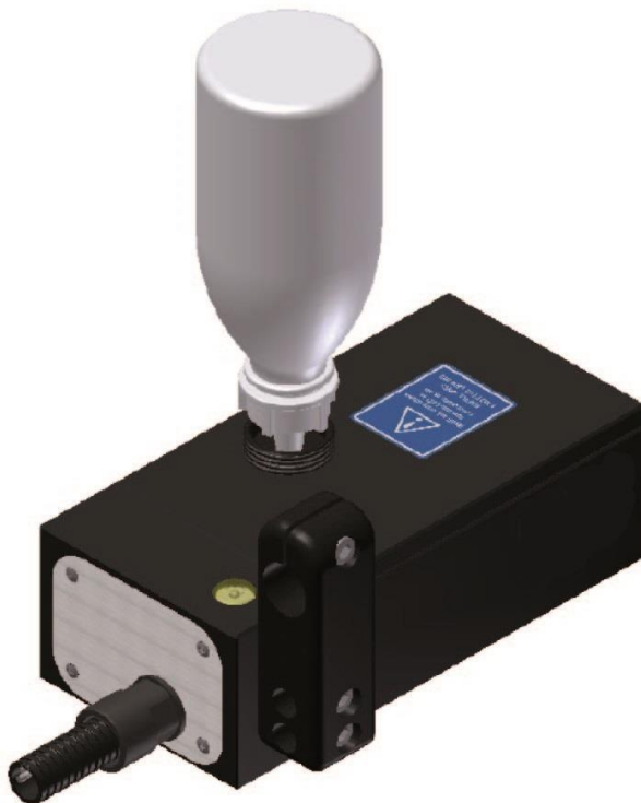
Fig. 8.21 Inktreservoir met inktfles
