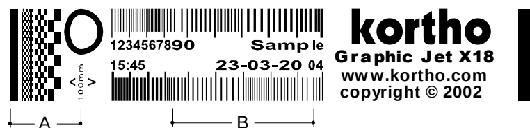
Fig. 9.45 Proefafdruk met variërende productsnelheid
