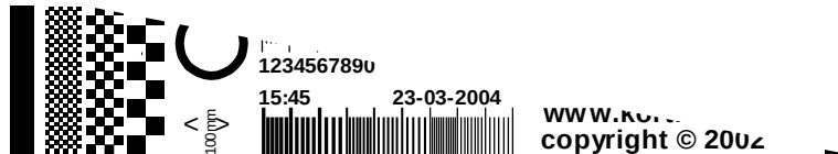
Fig. 9.41 Afdrukresultaat met luchtballen in de inkt of met verminderde inkttoevoer
