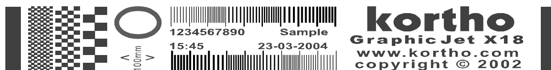
Fig. 9.44 Proefafdruk te langzaam afgedrukt, lengte > 100 mm (X7: > 175 mm)
