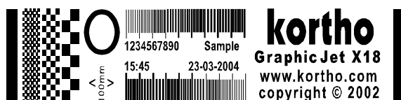
Fig. 9.43 Proefafdruk te snel afgedrukt, lengte < 100 mm (X72 < 175 mm)
