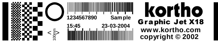
Fig. 7.11 Testlabel gemaakt met een juiste snelheidinstelling (X18)
