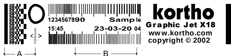
Fig. 9.45 Proefafdruk met variërende productsnelheid
