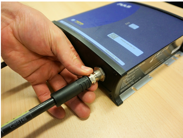
Imagen 5-2: Conector de alimentación
