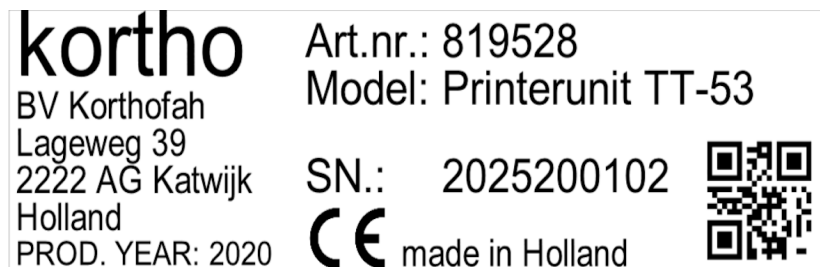
Imagen 1-1: Ejemplo de placa de características
