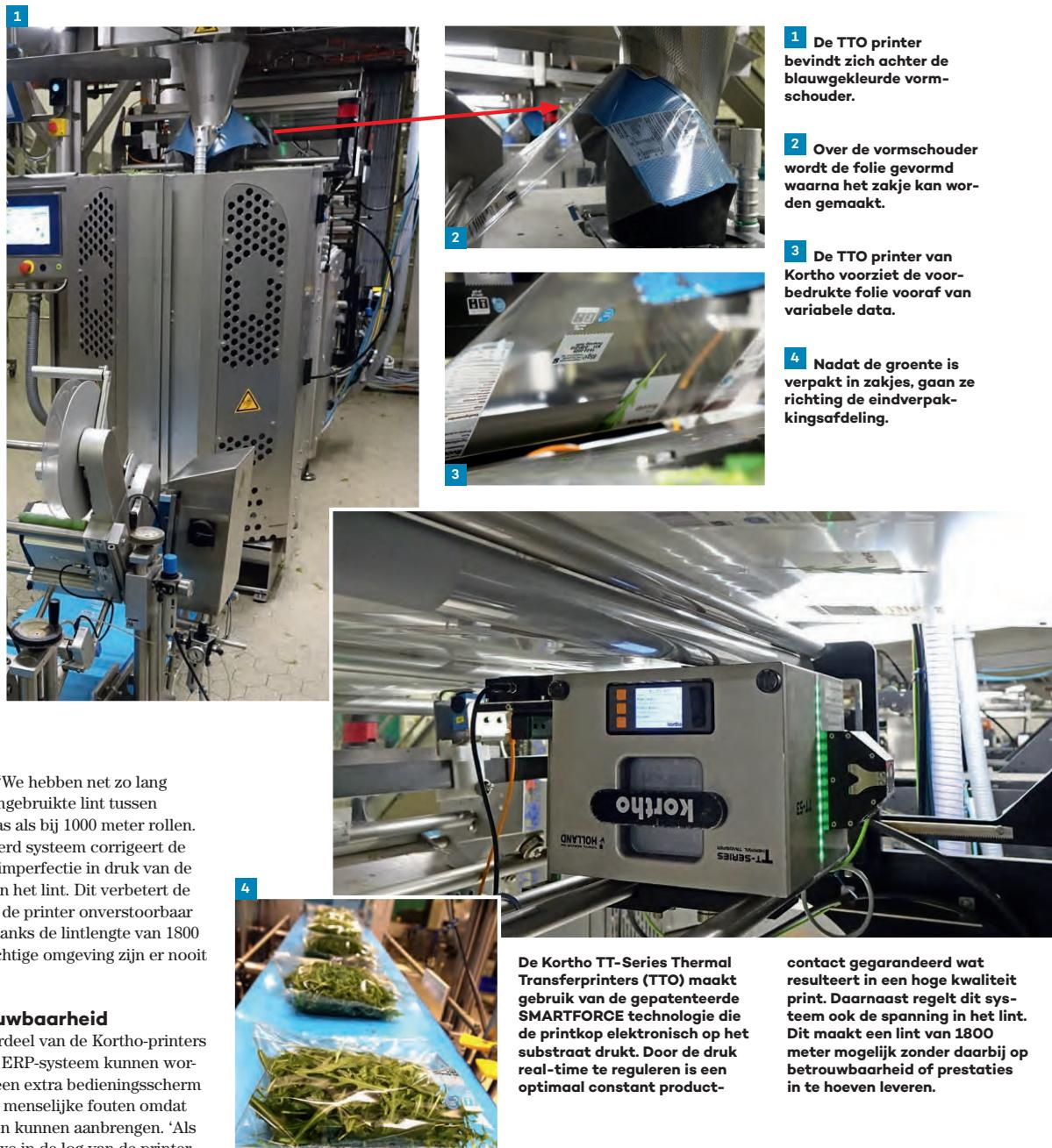
opgelost', zegt De Groot. 'We hebben net zo lang geoptimaliseerd tot het ongebruikte lint tussen afdrukken net zo klein was als bij 1000 meter rollen. En dankzij een gepatenteerd systeem corrigeert de printer automatisch elke imperfectie in druk van de printkop én de spanning in het lint. Dit verbetert de afdrukkwaliteit en maakt de printer onverstoornbaar en vergevingsgezind. Ondanks de lintlengte van 1800 meter en de koude en vochtige omgeving zijn er nooit lintbreuken of storingen.'
